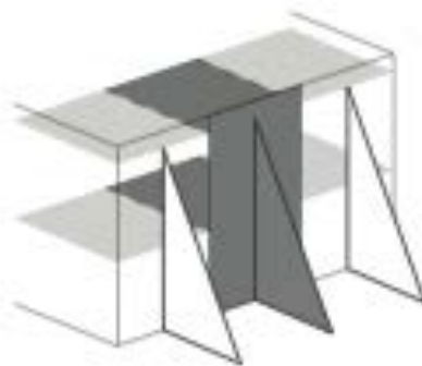
Rappresentazione delle aree di influenza per il puntello centrale (grigio). Al puntello viene assegnato il carico di parte della muratura e parte dei solai.
